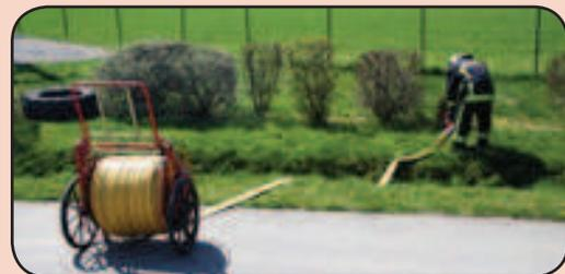
Le dévidoir mobile peut être utilisé comme dévidoir fixe dans certaines situations où celui-ci ne peut plus être mis en œuvre facilement (obstacle, neige, terre, barrière, franchissement d'une porte,...)
