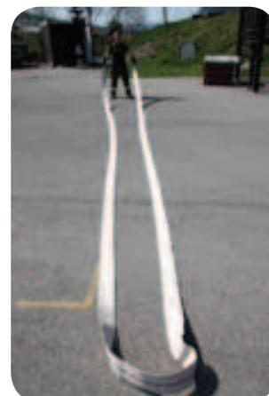
**Ecarter les bras afin d'arranger le tuyau en boucle**
