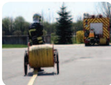
*Remarque : pour une meilleure mise en œuvre, le tuyau doit passer sous le dévidoir !*
