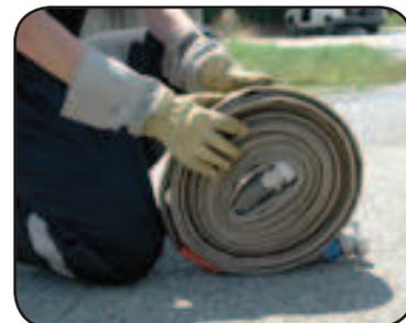
Afin de faciliter l'évacuation de l'eau, il est préférable de disposer le tuyau en pente et de commencer l'enroulement par le 1/2 raccord situé au point le plus haut.
