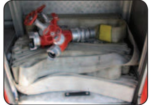
Les tuyaux de 110 sont roulés en coffre à plat et en accordéon.
