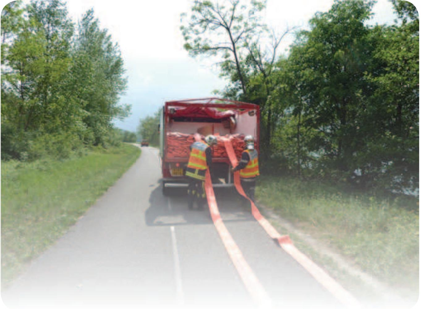
Traditionnellement réservé en France aux gros tuyaux (110 mm dans les camions dévidoir par exemple) le conditionnement en écheveau des tuyaux d'alimentation permet une certaine facilité dans l'établissement et le reconditionnement.
